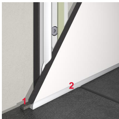
Obrázek 32: Montáž spojená s podlahou v oblasti sprchy
