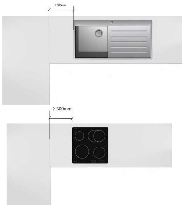
Obrázek 48: Správný minimální odstup 300 mm
