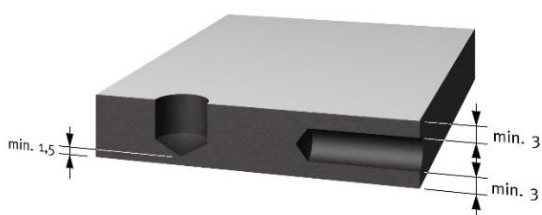
Obrázek 5: Minimální odstupy vrtných otvorů od okraje desky
