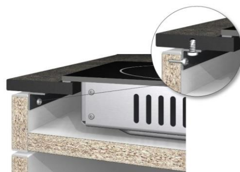
Obrázek 51: Stabilizování pomocí ocelových traverz
