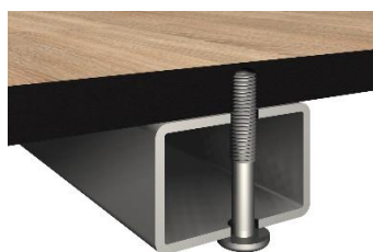
Obrázek 40: Doporučené uchycení kompaktních desek
