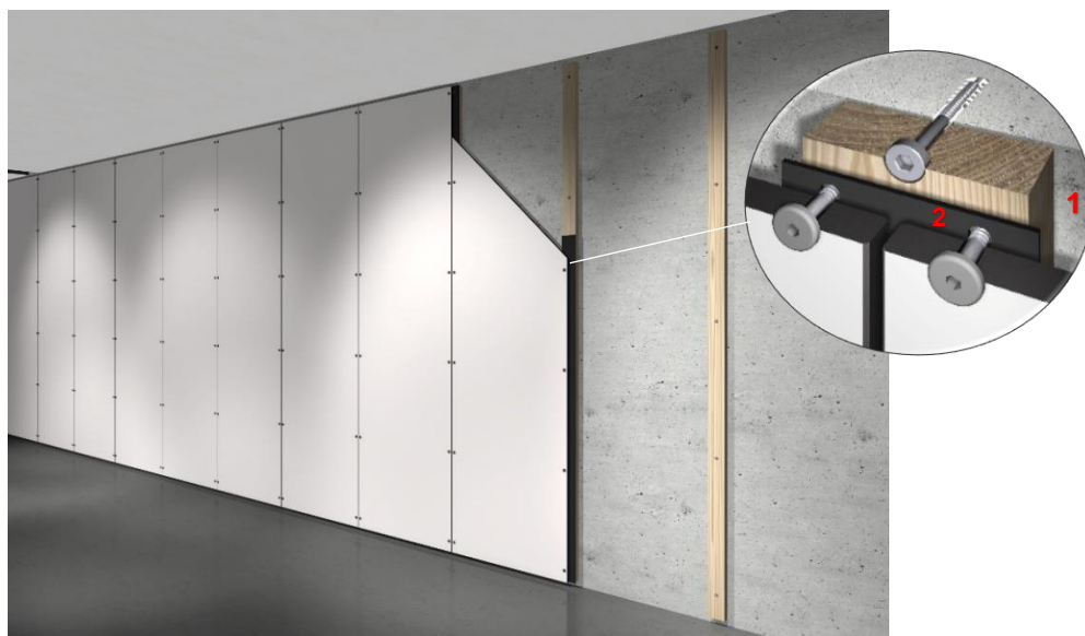
Obrázek 25 Viditelné mechanické uchycení
