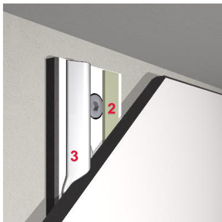
Obrázek 30: Ukončení stěnového obkladu nahoře
