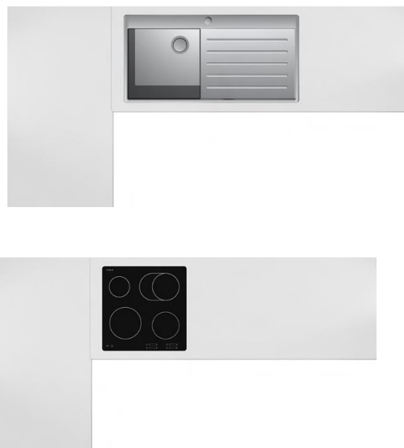
Obrázek 49: Chybný minimální odstup
